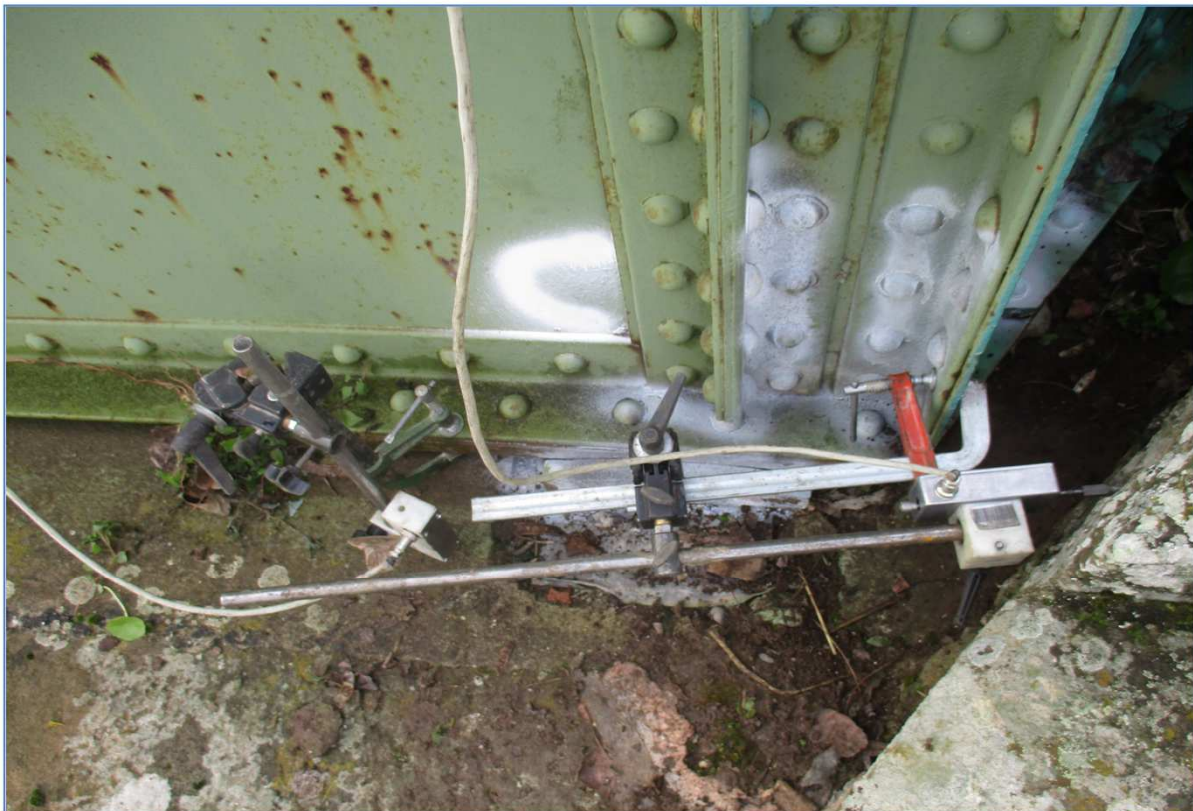
Trasduttori elettronici per il rilievo degli spostamenti dell'appoggio
