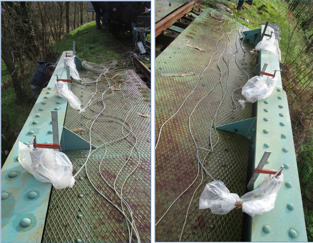
Inclinometri monoassiali per il rilievo delle rotazioni delle sezioni
