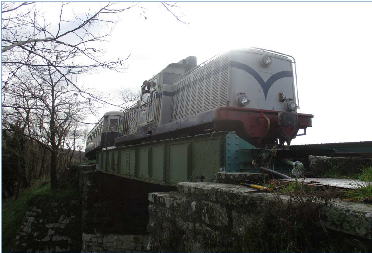
Locomotori utilizzati per l'applicazione del carico - Configurazione di carico n. 1
