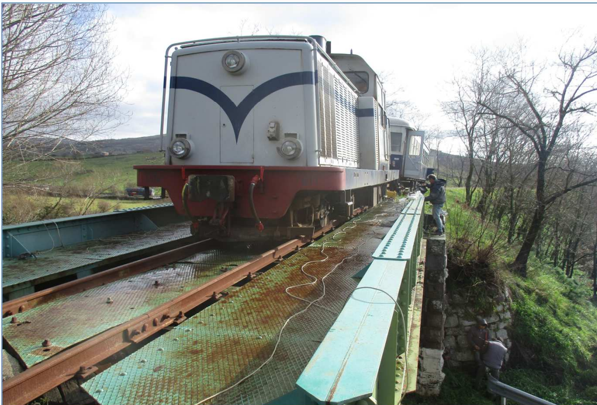
Locomotori utilizzati per l'applicazione del carico - Configurazione di carico n. 2
