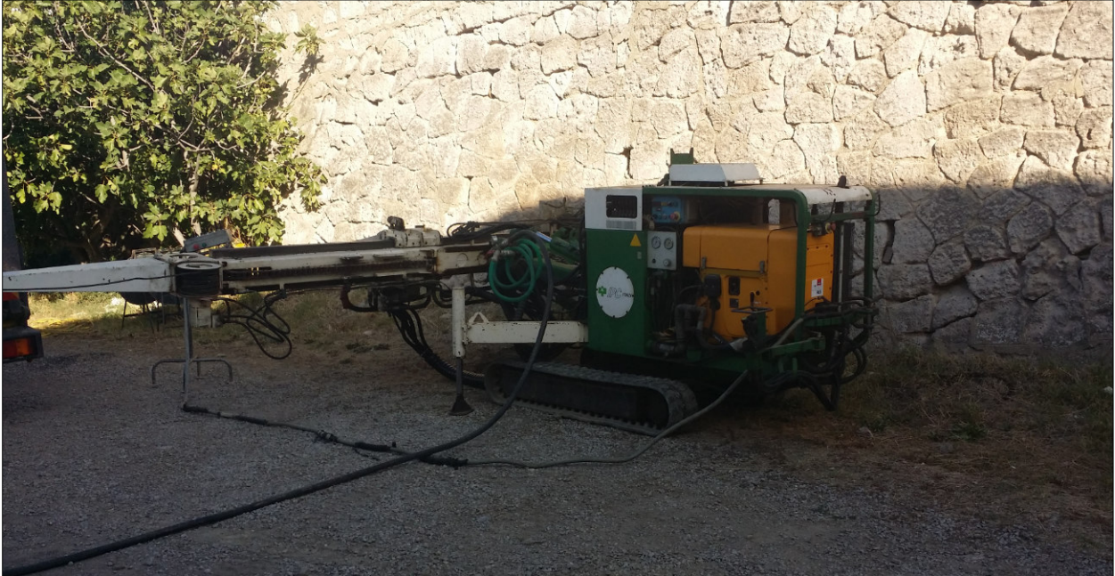
FIGURA 11 - Posizionamento sondaggio S1, orizzontale. Il foro è stato effettuato a +1.0 m dal p.c.
