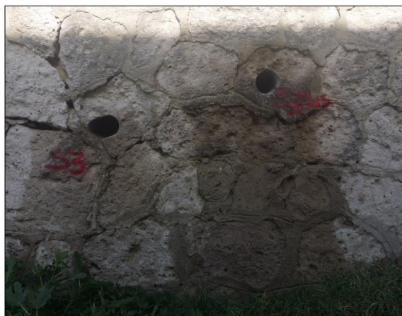
FIGURA 13 - Posizionamento sondaggi S3 e S3bis, entrambi orizzontali.
