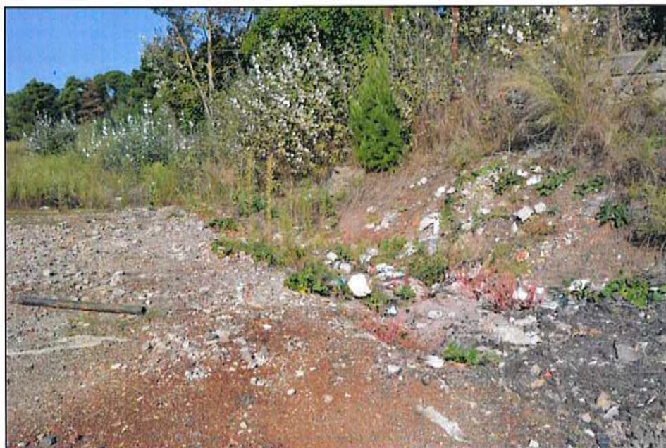
Foto 4.1: Materiali di natura antropica (terre di riporto) visibili sul piazzale oggetto della bonifica bellica
